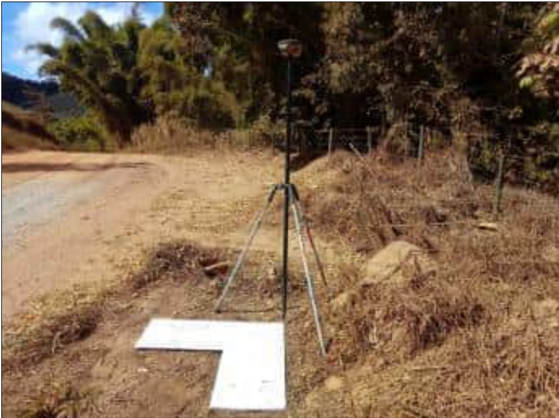
Figura 10. Exemplo de uma estação Ground Control Point (GCP) utilizada em campo.
