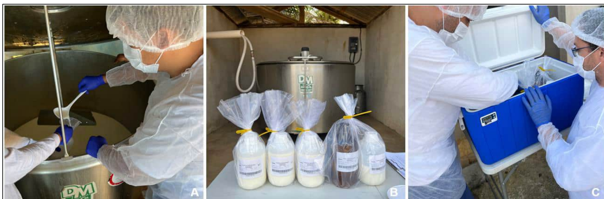
Figura 15. Procedimentos de coleta e amostragem de leite. (A) Coleta do leite, (B) embalagem e identificação e (C) armazenamento em caixa térmica para transporte para a base de apoio.
